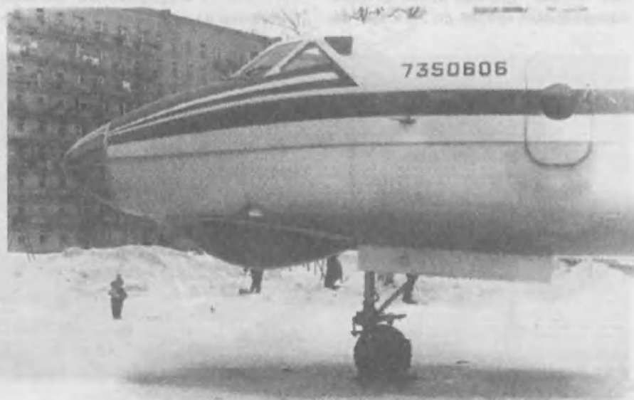
Носовая часть Ту-124Ш с обтекателем РПС «Рубин-1А».
